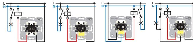
**Bild 1:** Taster, Schließer / Taster beleuchtet: Nur eine begrenzte Anzahl Taster sind parallel zu schalten oder der Neutralleiter ist mitzuführen / Taster dauerbeleuchtet\*: Beliebig viele Taster parallel schaltbar, der Neutralleiter ist mitzuführen / Kontrollschaltung\*
