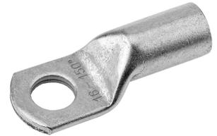
Rohrkabelschuh, Normalausführung, Ringform, bis 6 mm<sup>2</sup> mit Sichtloch, aus galvanisch verzintem E-Cu-Rohr, Leiterquerschnitt/ Anschlussbolzen 6 mm<sup>2</sup>/8mm
