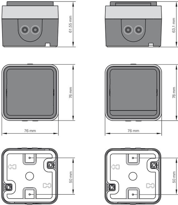
**Bild 1:** Schalter/Taster (links), Steckdose SCHUKO mit Klappdeckel (rechts)
