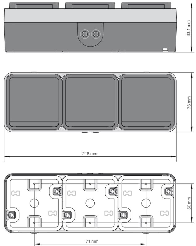
**Bild 4:** Steckdose SCHUKO 3fach mit Klappdeckel
