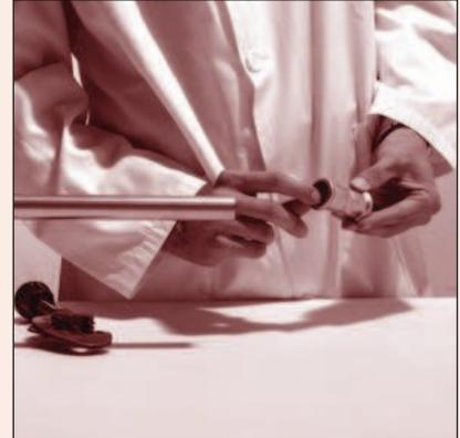
**Fig. 23** Verifica della presenza e del posizionamento degli o-ring
