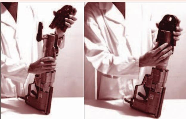
**Fig. 27** Attrezzaggio delle pressatrici
