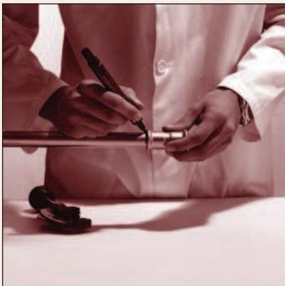
**Fig. 24** Inserimento dei tubi nei raccordi e segnatura del corretto posizionamento.
