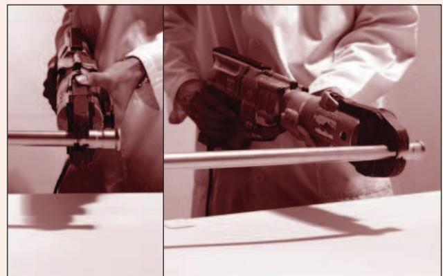
**Fig. 28** Pressatura
